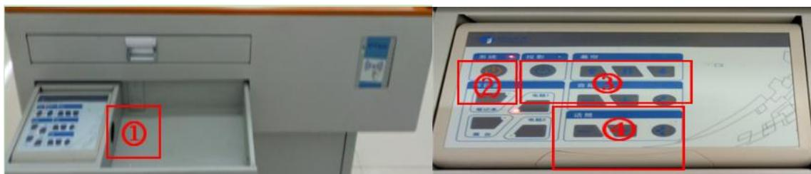
1. 讲台电源开启：上课教师在讲台前方位置①处拉开控制面板抽屉后，按控制面板系统②键开机。
